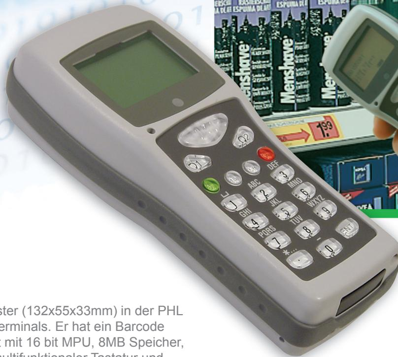
Der PHL 1300 ist unser kleinster (132x55x33mm) in der PHL Produkt-palette der mobiler Terminals. Er hat ein Barcode Laserscanner integriert. Er ist mit 16 bit MPU, 8MB Speicher, grafikfähigem LCD Display, multifunktionaler Tastatur und IrDA Schnittstelle ausgestattet.
