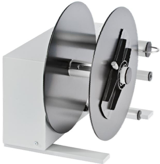
Mit der externen Aufwickelvorrichtung PR 12 lassen sich Etikettenrollen bis zu einem Druckmesser von 300 mm verarbeiten. Durch ein internes Netzteil ist die Aufwickelvorrichtung für alle Druckertypen gleichermaßen geeignet. Für eine gleichmäßige und straffe Wicklung sorgt bei allen Aufwickelvorrichtungen eine elektronische Regelung über den Pendelarm.
